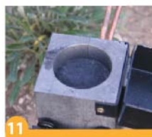
11 Düzeltilmiş Termokaynak Tozu pota içinde ,Ateşleme Tozunun ilave edilmesi için hazırdır.
