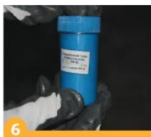
6 Termokaynak tozunu elinize alınız.
