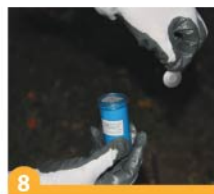
8 Kutu içinde bulunan metal plakayı pota dibine düzgünce oturtunuz ve atesleyici tozu (küçük poşet içinde) ayırınız.
